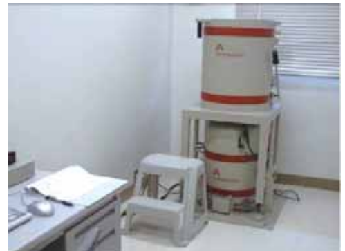
放射性物質の測定器（ゲルマニウム半導体検出器）
