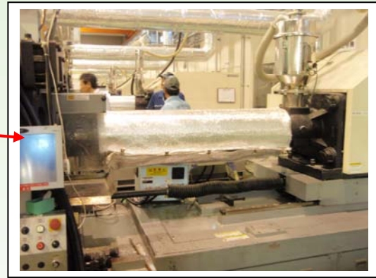
<放熱部分を断熱シートで覆う>
