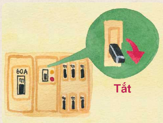
Cầu giao điện
