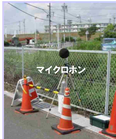
騒音測定状況 (写真はイメージ)
