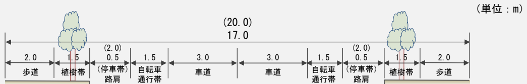
図31：都市計画道路の標準的な幅員構成
